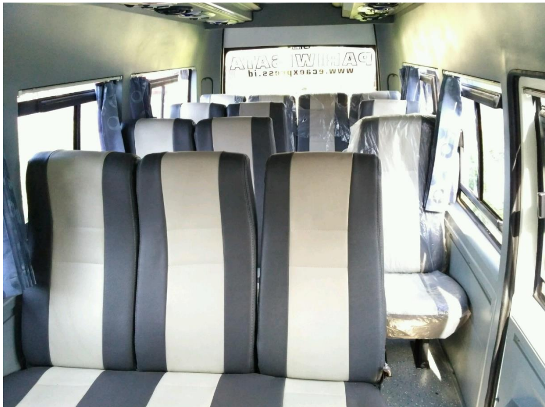
Gambar 23. Ruang penumpang tidak ada sabuk keselamatan
