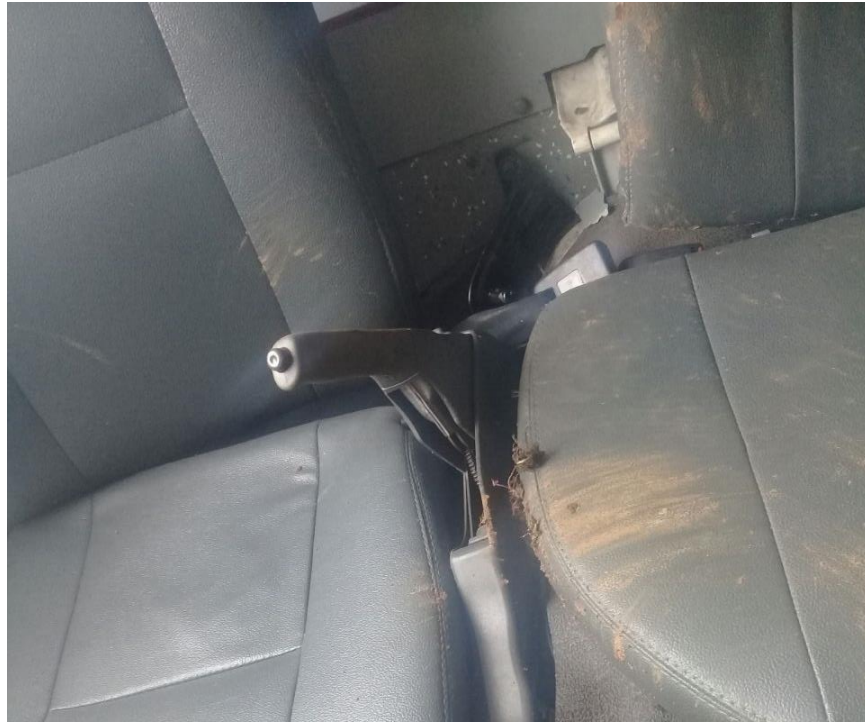
Gambar 7. Posisi tuas rem tangan tertarik penuh.
