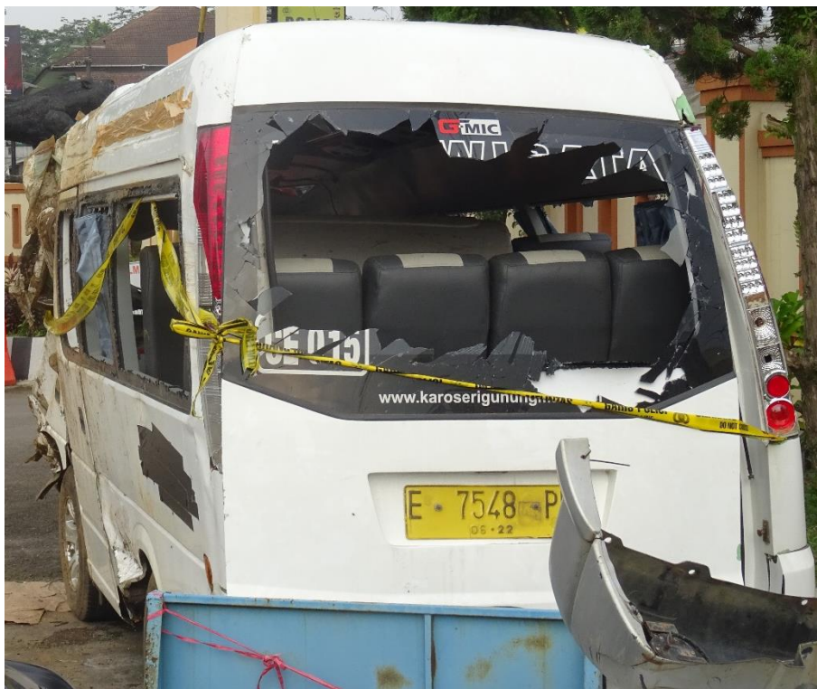
Gambar 5. Tampak belakang kerusakan mobil elf E-7548-PB.
