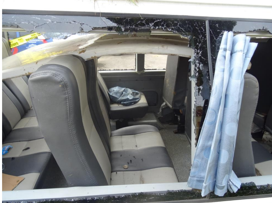
Gambar 9. Kondisi tempat duduk penumpang tidak ada sabuk keselamatan.
