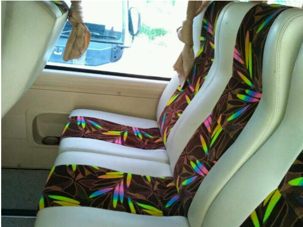
Gambar 25. Ruang penumpang tidak ada sabuk keselamatan
