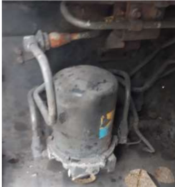
Gambar 17. Pipa dari Kompresor Ke Air Dryer Menuju Air Tank Masih Terpasang
