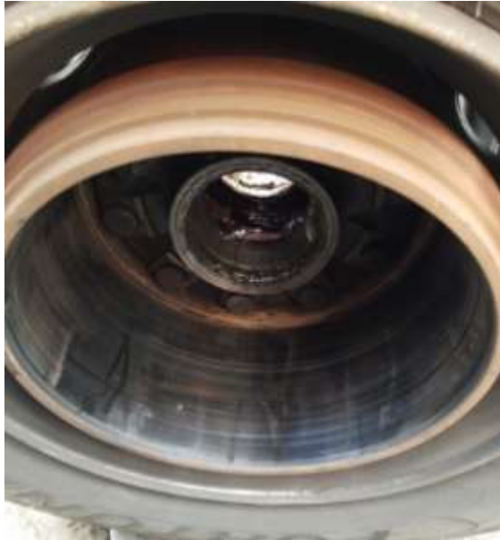
Gambar 10. Permukaan Brake Drum Normal / Tidak Aus
