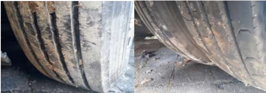
Gambar 15. Tebal Telapak Ban Roda Depan dan Belakang > 1mm
