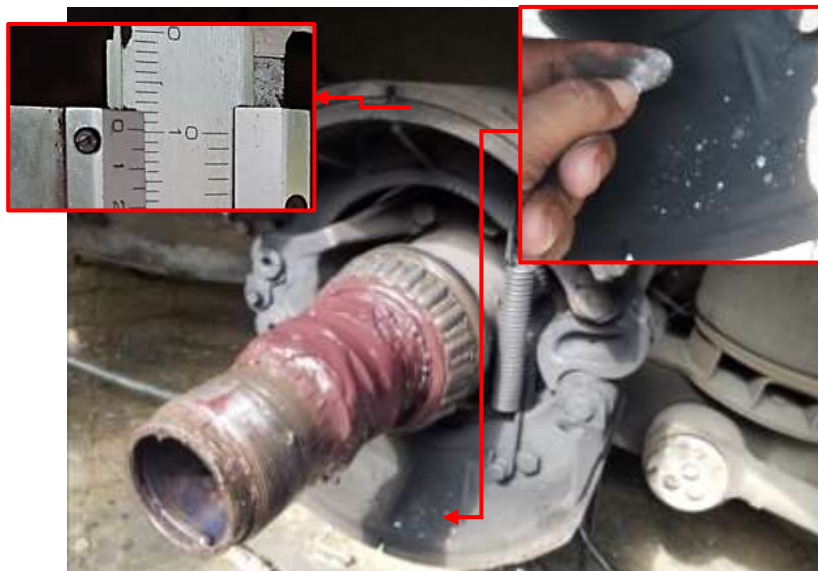
Gambar 11. Tebal Kampas Rem 10 Mm, Terdapat Residu di Sepatu Rem dan Kondisi Grease Bearing Meleleh
