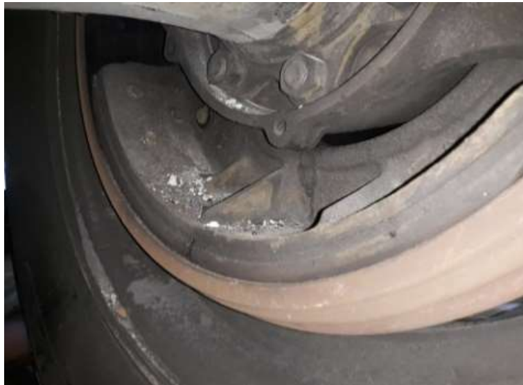
Gambar 9. Kondisi Dust Cover Tidak Terpasang dan Terdapat Residu Kampas Rem
