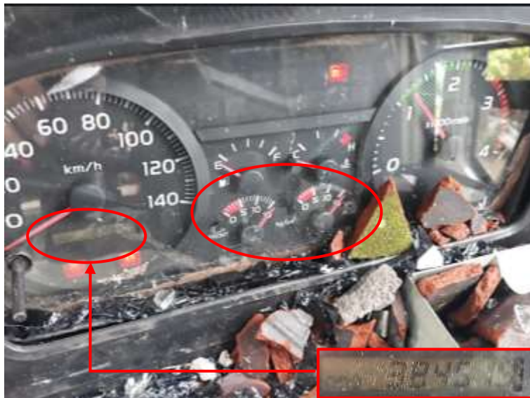
Gambar 13. Indikator Tekanan Udara Rusak, Odometer 384.615 km
