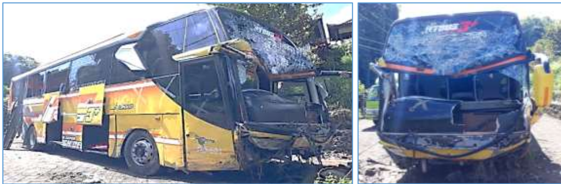
Gambar 2. Bodi Depan Mobil Bus Terdeformasi
