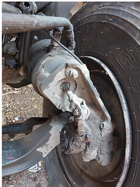
Gambar 11. Kondisi komponen sistem rem di roda kotor
