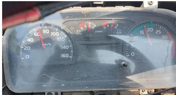
Gambar 9. Indikator speedometer di angka 62 km/jam di 1700 RPM dan indikator tekanan udara angka 8 bar
