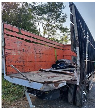
Gambar 21. Bagian belakang kanan rangka besi bak kayu terdeformasi
