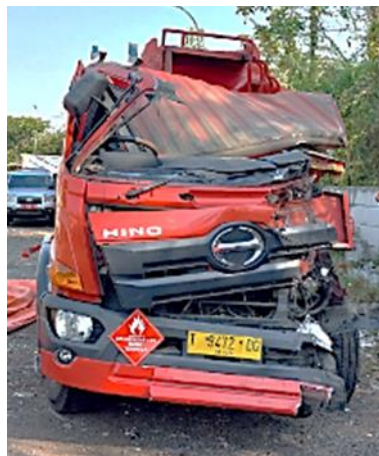
Gambar 3. Kabin truk terdeformasi di bagian kiri
