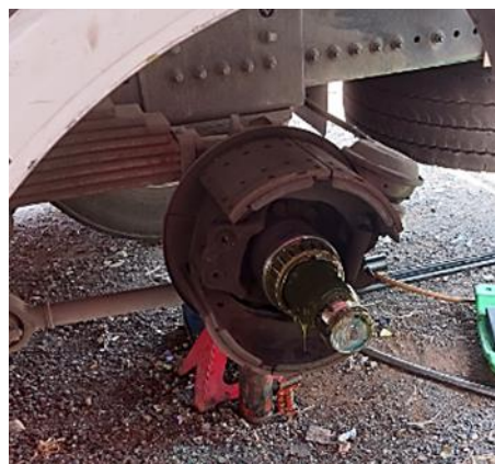
Gambar 15. Komponen rem di roda belakang kiri terpasang lengkap
