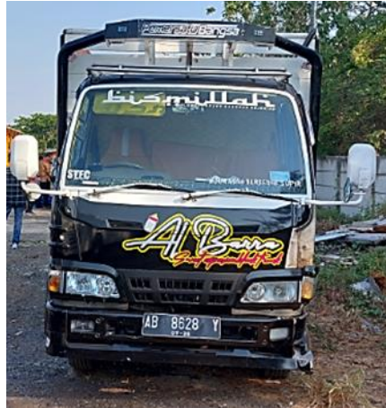
Gambar 19. Kabin depan truk bak terbuka tidak terdeformasi
