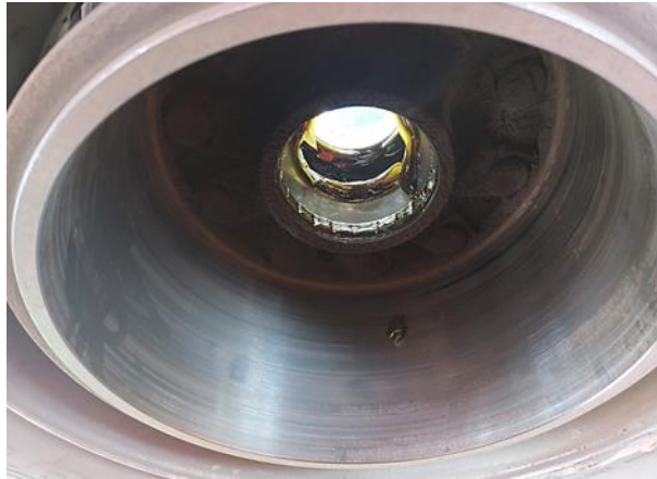
Gambar 16. Permukaan dalam tromol tidak aus
