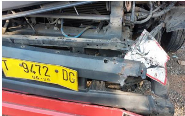
Gambar 8. Plat besi dudukan fiber bemper bagian kiri terdeformasi
