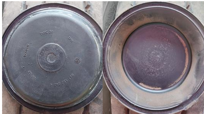
Gambar 17. Diafragma chamber rem kondisi tidak bocor
