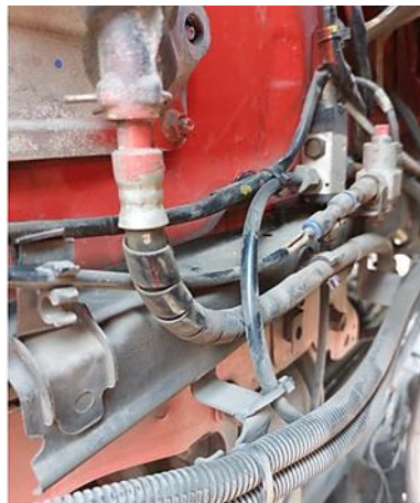
Gambar 12. Klakson tambahan terinstal pada selang suspensi udara tempat duduk pengemudi
