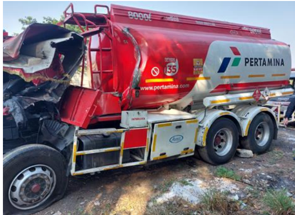
Gambar 7. Bagian kiri tangki plat besi terdeformasi
