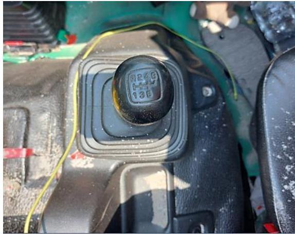
Gambar 10. Roda gigi persneling 6 kecepatan dan roda gigi mundur
