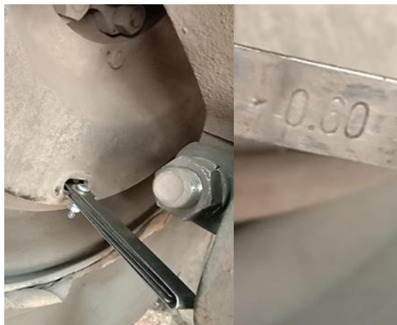
Gambar 14. Jarak antara kampas rem ke tromol 0,60 mm
