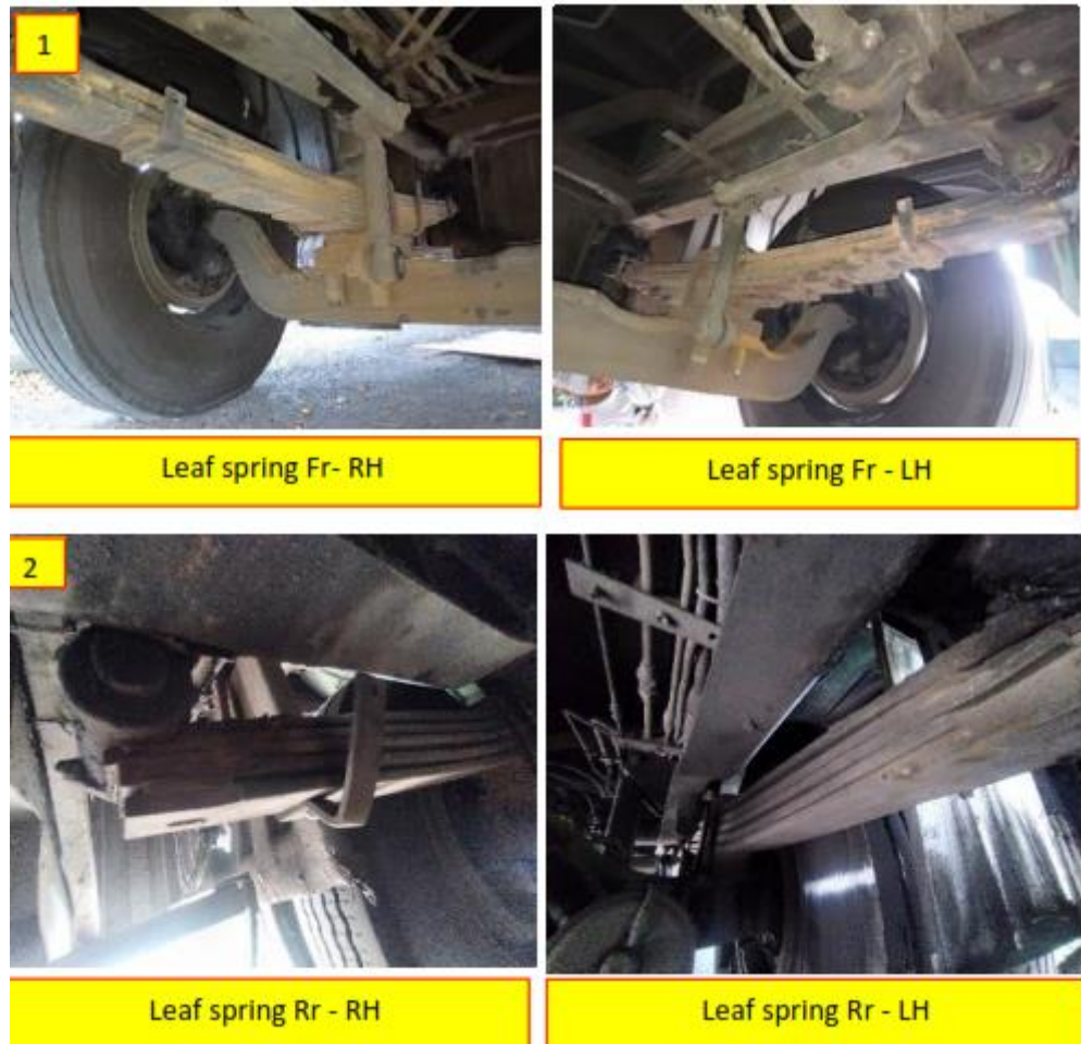
Gambar 16. Pemeriksaan spring depan dan belakang, kondisi spring standar tidak ditemukan kerusakan
