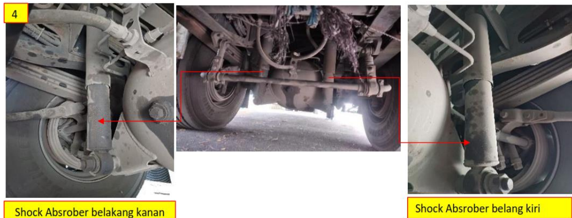
Gambar 18. Pemeriksaan shock absorber depan, tidak terlihat kebocoran (adapun terlihat basah bukan dari minyak shock absorber), kondisi karet baik dan pin dan braket kondisi baik
