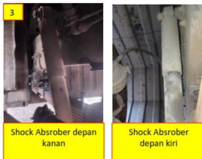
Gambar 17. Pemeriksaan shock absorber depan, tidak terlihat kebocoran (adapun terlihat basah bukan dari minyak shock absorber), kondisi karet baik dan pin dan braket kondisi baik
