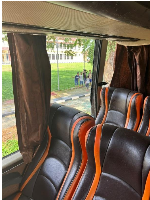
Gambar 9. Akses pintu darurat di dinding kanan terhalang kursi penumpang
