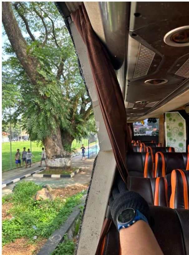
Gambar 7. Deformasi superstruktur bus pada tiang jendela
