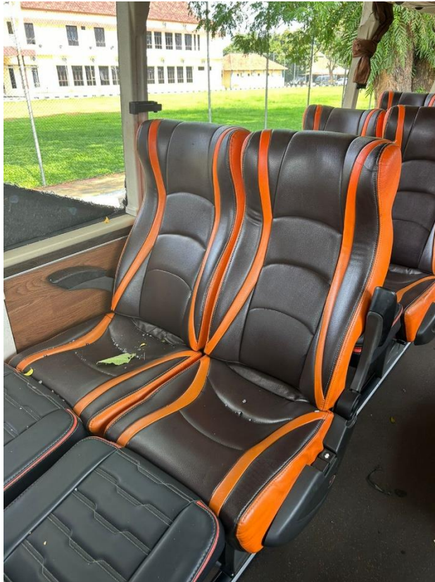
Gambar 8. Kursi penumpang tidak terpasang sabuk keselamatan
