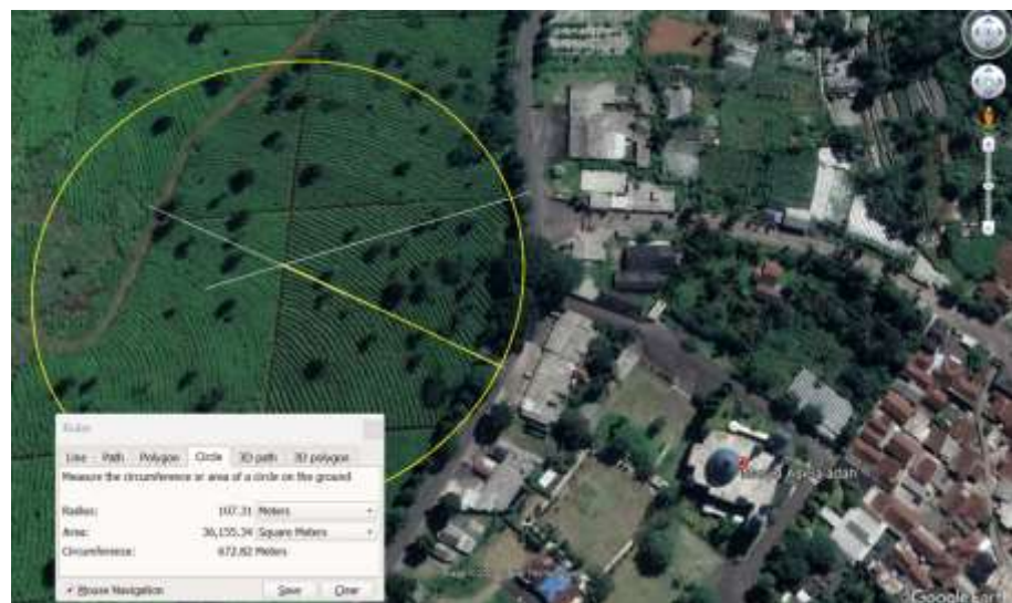
Gambar 6. Alinyemen Horizontal di tikungan ke-1 sebelum lokasi kecelakaan dengan radius 107 meter
