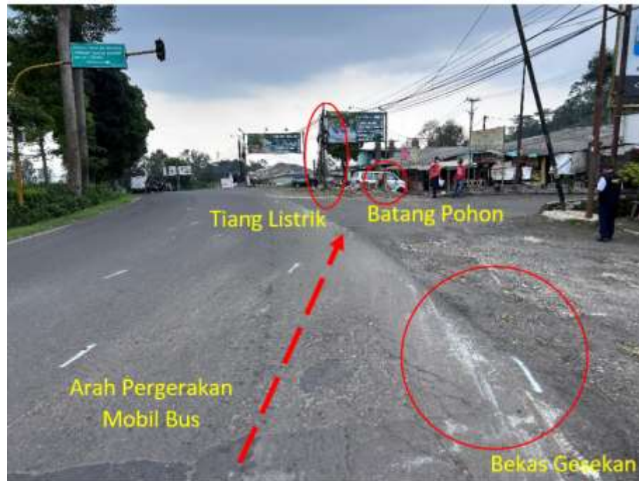
Gambar 11. Tidak ditemukan jejak pengereman dan terdapat bekas gesekan antara bodi Mobil bus dan jalan serta terdapat batang pohon di arah jejak gesekan
