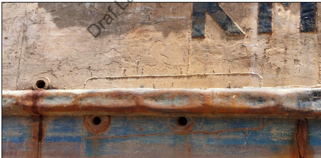
Gambar II-3: Lubang pembebasan ( freeng port ) yang ditutup saat docking
