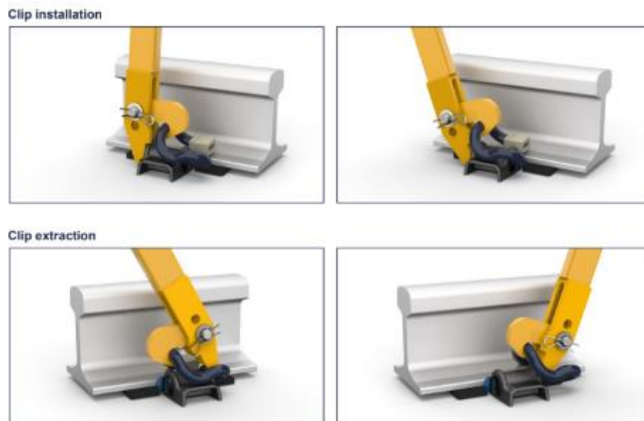
Gambar 31. Cara memasang dan melepas E-Clip, Pandrol
