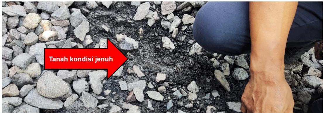
Gambar 17. Kondisi tanah basah di jalur hulu (digali, 05-10-2022)
