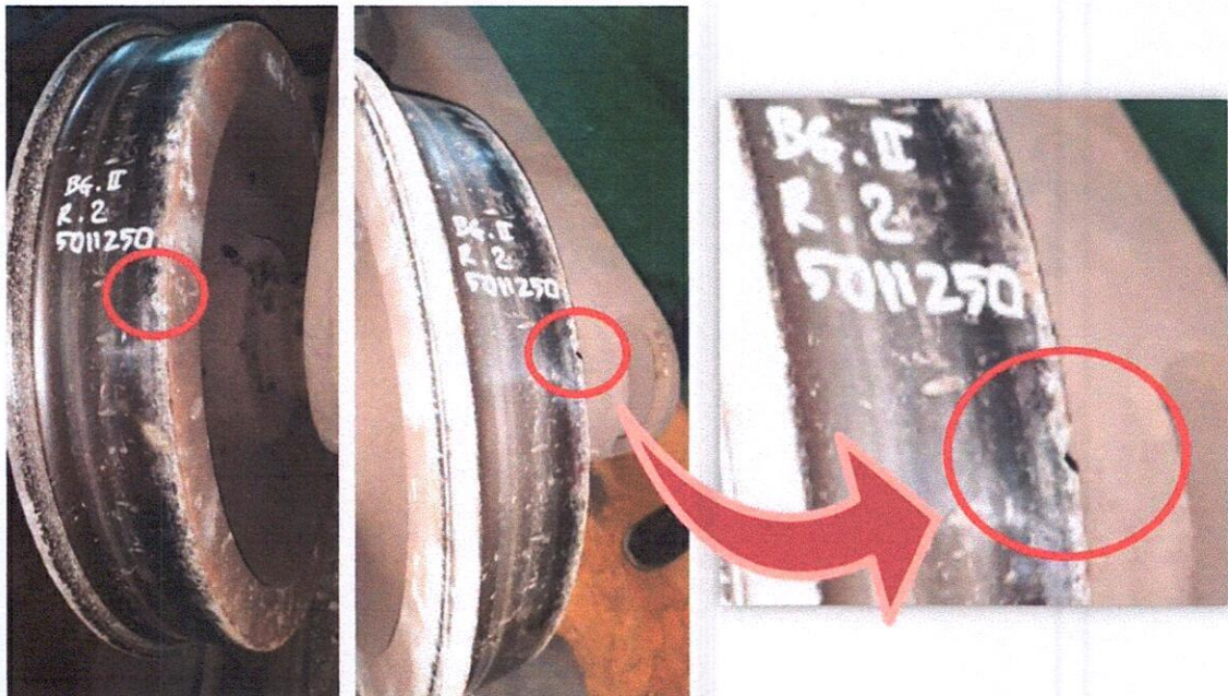
Gambar 10. Kerusakan roda GB 50 11 250 (roda 2 bogie II)
