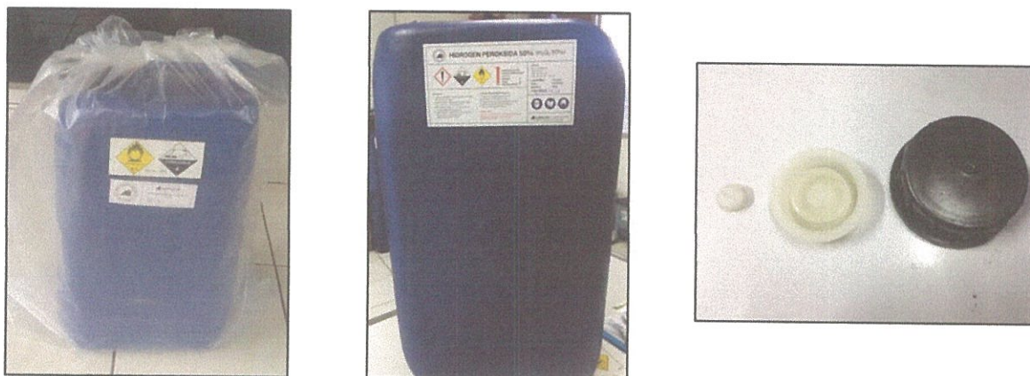
Gambar I-8 Kemasan Jeriken Hidrogen Peroksida Dibungkus Plastik dan Tutupnya Berventilasi (sumber: PT SI)
