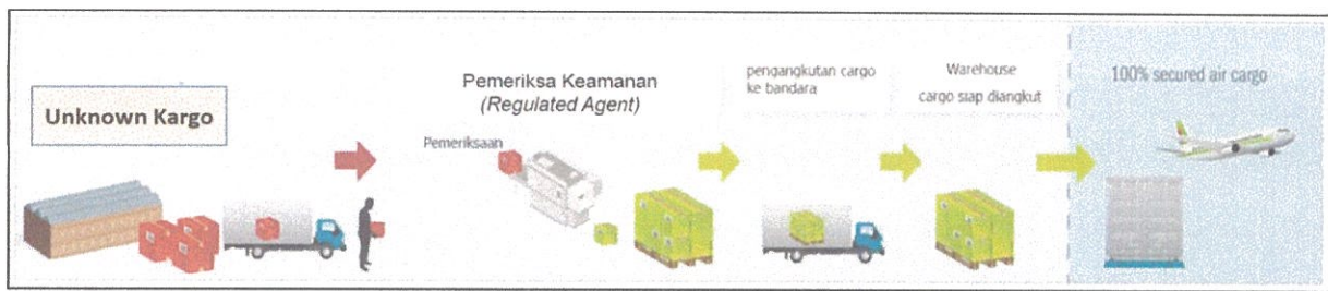
Gambar I-11 Alur Pemeriksaan Kargo yang Dimuat di Pesawat Udara
